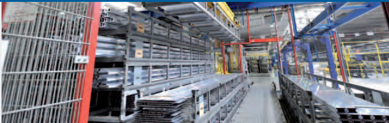
proALPHA erzeugt den Transportauftrag für die Profile und sendet ihn an das Transportleitsystem der Automatikkrane.
