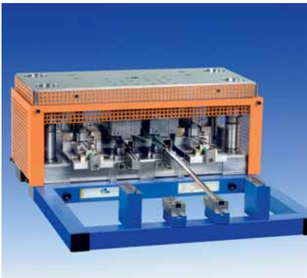
Biege- und Beschneidewerkzeug
